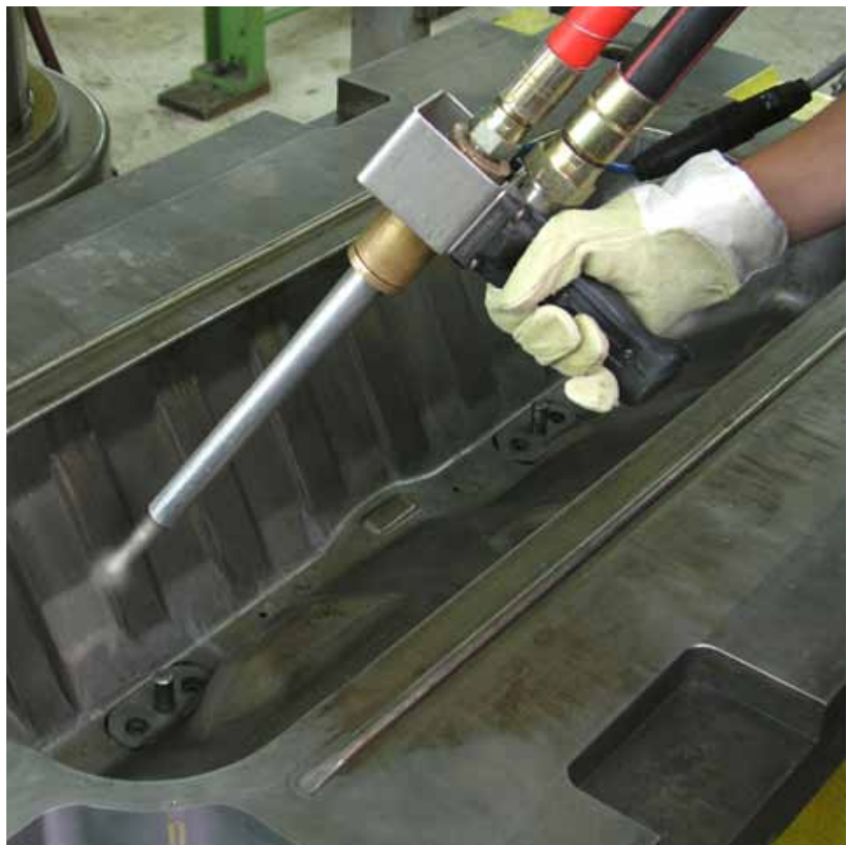
Formenreinigung mit Trockeneisstrahlen
