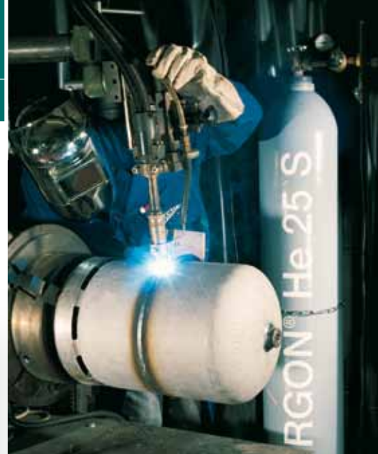
Schweißen mit dem Schutzgas »Corgon« von Linde (Foto: Linde AG)
