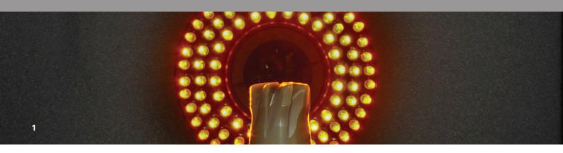
1 Prototyp eines Stirnfräsers aus SiAION-Keramik
