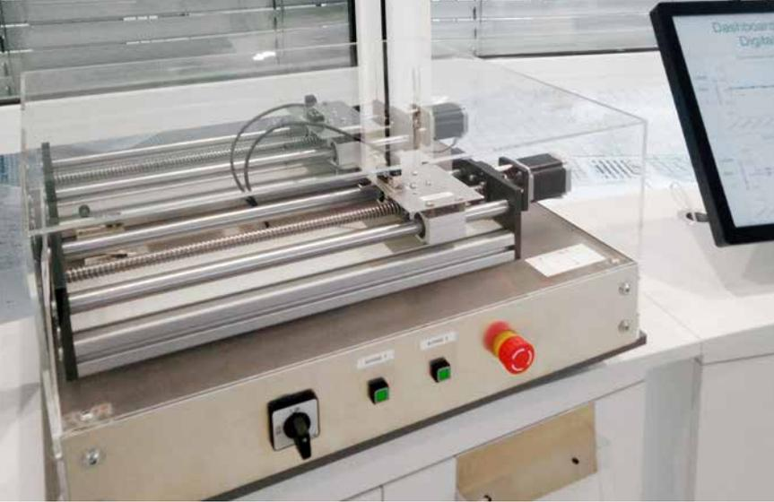
Demonstrator mit zwei Kugelumlaufspindeln und Dashboard
