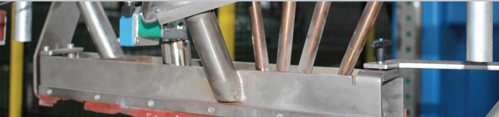
Schweißkopf der 5-Draht-UP-Schweißanlage
