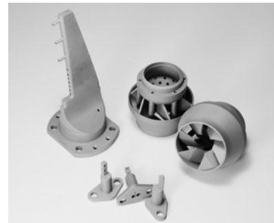
Generativ gefertigte Bauteile. Bild: Fraunhofer IPK
