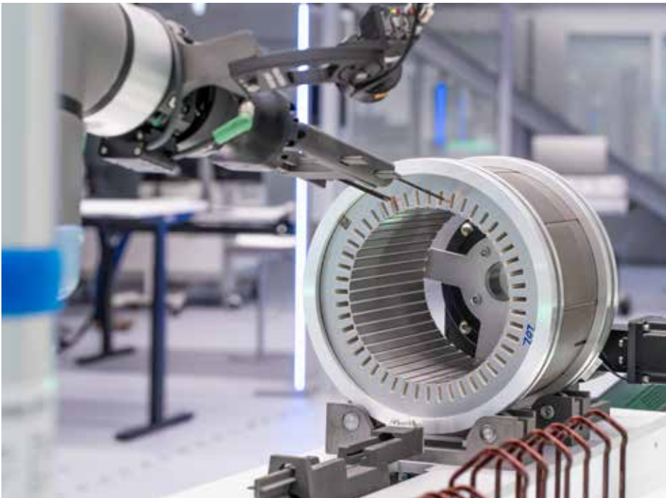
Bilder: 1 Einfügen von Hairpins in einen Stator mithilfe eines Cobots 2 Umweltfreundlich, präzise und rückstandsfrei reinigen mit Kohlenstoffdioxid
