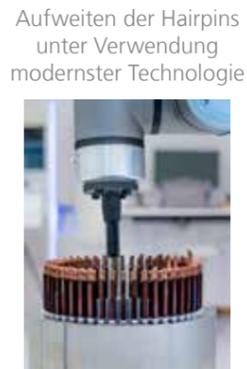
Aufweiten der Hairpins unter Verwendung modernster Technologie
