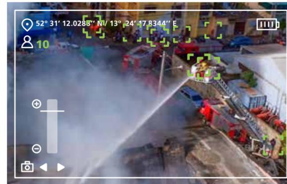
Die Software erlaubt auch die anschließende Kommunikation direkt zwischen dem Drohnenanbieter und den Feuerwehrleuten. Sie erhalten ein Token, mit dem sie auf die Echtzeit-Videobilder der Drohne zugreifen und die Kamera nach Bedarf einstellen können, um beispielsweise Wärmebilder anzuzeigen oder gefährdete Personen aus der Luft zu erkennen.
