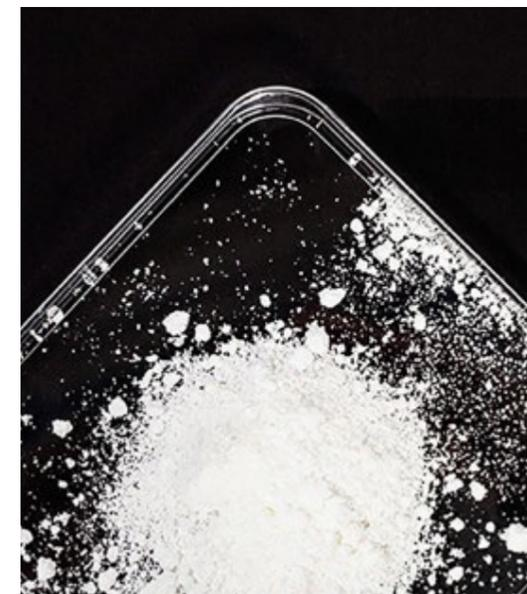
So sieht das Rohmaterial des Biopolymers PHB direkt nach der Synthese aus.
