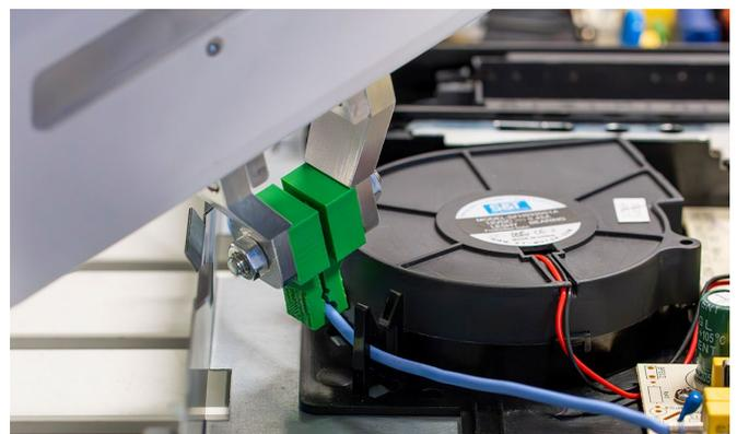
Erprobung des automatisierten Verlegens von Kabeln mit Robotern in den Laboren des Fraunhofer IPK. © Fraunhofer IPK
