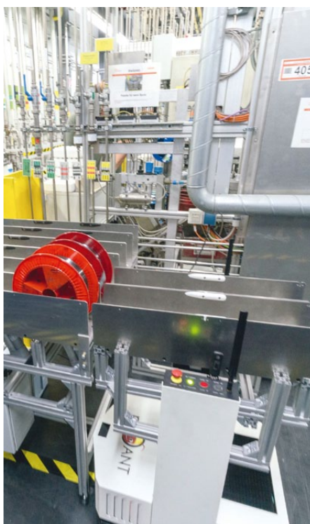
3 Abgeschlossene Übergabe der Spulen vom Transportfahrzeug an die Station
