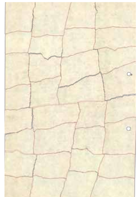
Vorder- und Rückseite einer Vollrekonstruktion mit rot hervorgehobenem Rissbild.
