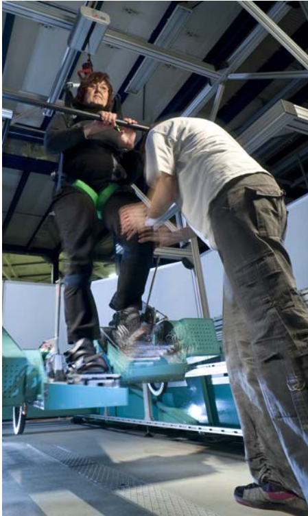
HapticWalker – Robotergestützter Laufsimulator für die motorische Gangrehabilitation (Forschungsprototyp)
