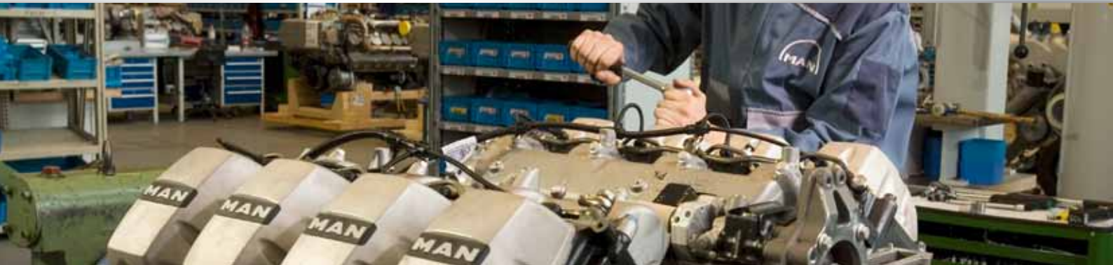
Montage eines LKW-Motors (Bild: MAN).
