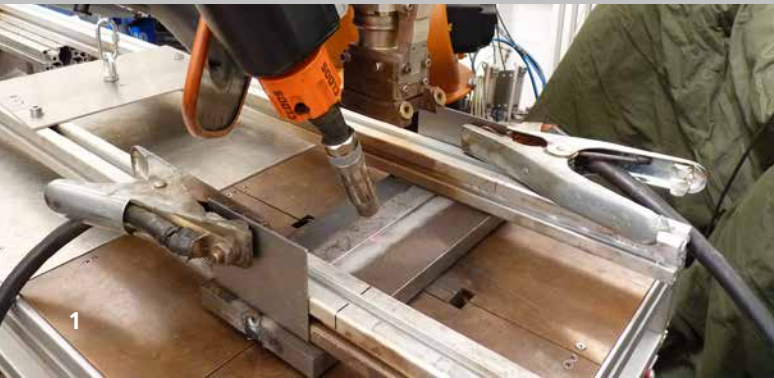
1 Versuchsaufbau während der Laserhybridschweißversuche mit elektromagnetischer Schmelzbadunterstützung
