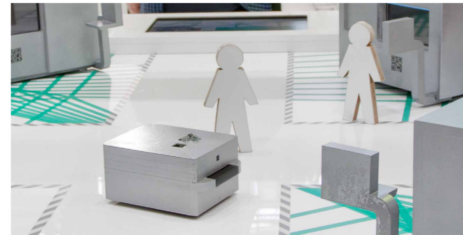
In der miniaturisierten Produktionshalle wird demonstriert, wie die digitale Vernetzung mehrerer Transportsysteme und Werkzeugmaschinen mittels optischer Drahtlostechnik funktioniert.
